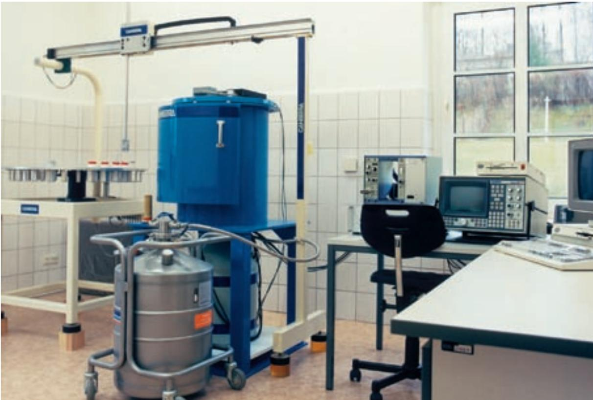
Abgeschirmte Messanordnung mit Halbleiterdetektor zur Bestimmung geringer Aktivitätskonzentrationen in Proben.
