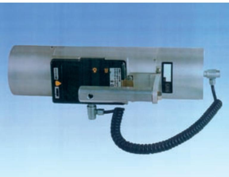
Strahlungsmessgerät mit Geiger-Müller-Zählrohr (in Kombination mit einem Szintillationsdetektor).
