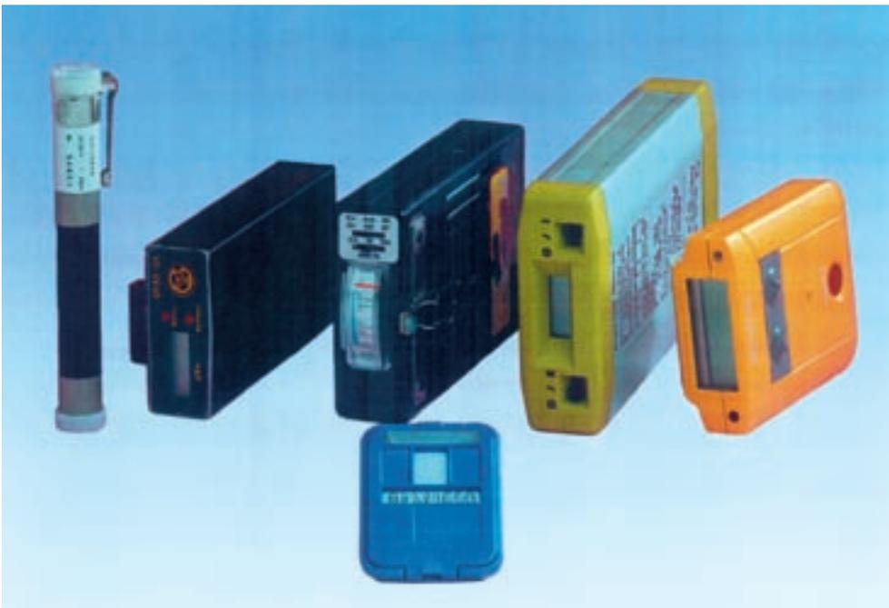
Verschiedene Strahlungsmessgeräte und Personendosimeter; vorn ein Film-dosimeter.
